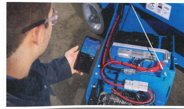
Die Lithium-Ionen-Batterie erreicht laut Testergebnissen von Genie eine Lebensdauer von rund zehn Jahren. Foto: Genie
