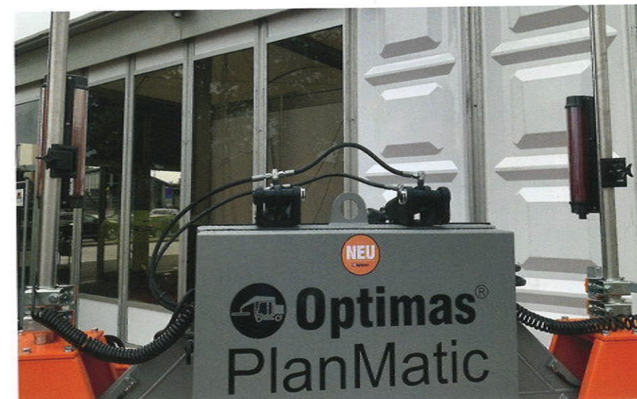
Das Optimas ALV hält den Längsneigungswinkel des Planmatic automatisch. (Foto: Optimas)
